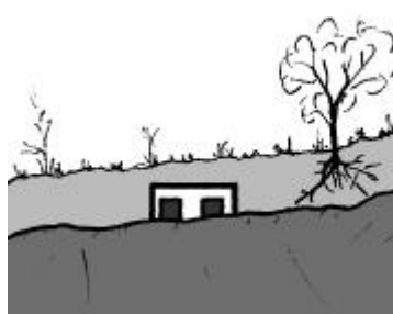
Figure 1.15. Mode d'installation choisi pour notre étude : les inclinomètres sont posés sur une coulée de lave massive recouverte naturellement par une épaisseur de terre (quelques mètres).
