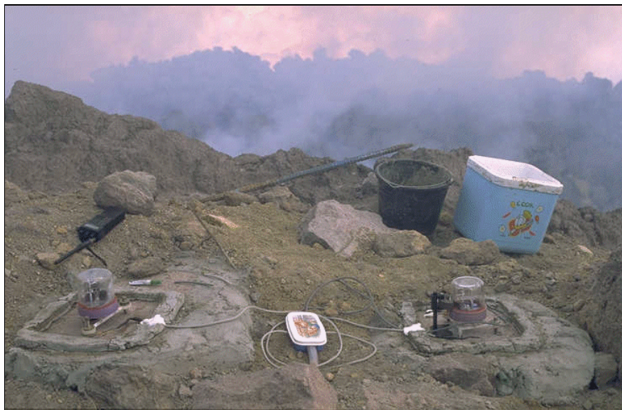
Photo 2.6. Installation de la station clinométrique de Lilik au bord du cratère sur Lava 56 . En arrière plan, le dôme de lave de 1995.
