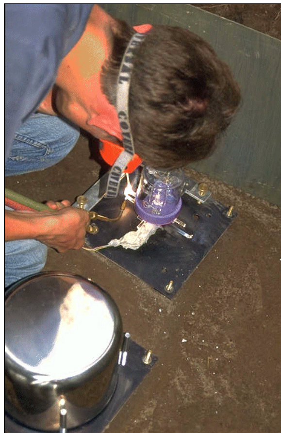
Photo 2.8. (a) Transport d'une bouteille de 80 litres d'acétylène à Deles . (b) Installation de l'inclinomètre CH427 à Deles (site 3) : soudure de la silice au chalumeau.
