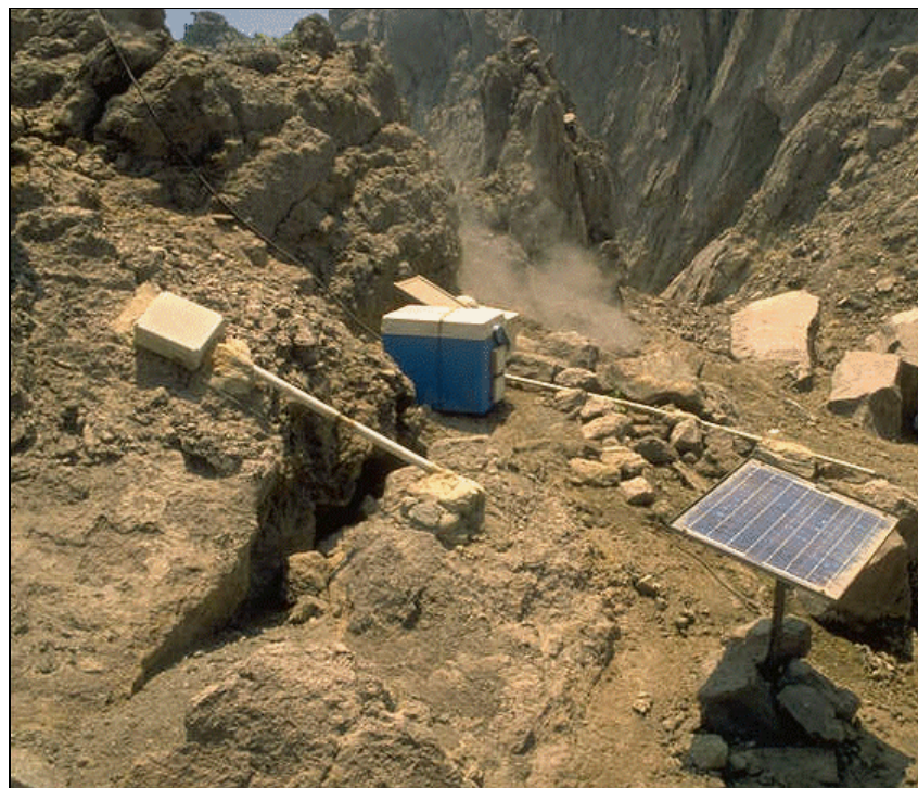
Photo 2.4. Deux extensomètres en parallèle sur la fracture Lava 56 . Au premier plan le capteur LGIT relié à la station LEAS n°2 et au second plan le capteur de la station Monoa .
