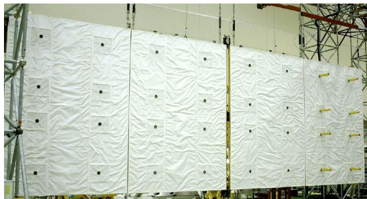
Figure 3.2. Antenne PALSAR (8,9 m × 3,1 m) durant un test de déploiement (Rosenqvist et al., 2004).
