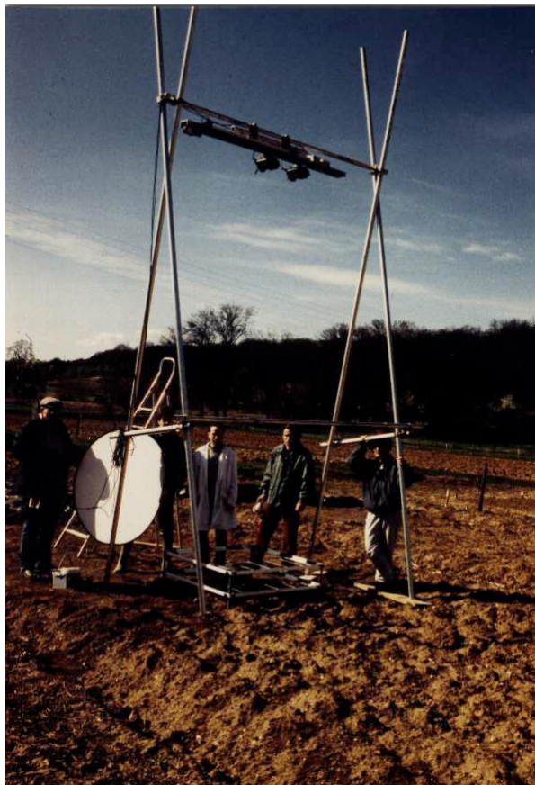
Figure 4.4. Acquisition d'un couple d'images à partir de deux caméras CCD situées sur une plateforme haute de 3 m (Zribi, 1998).
