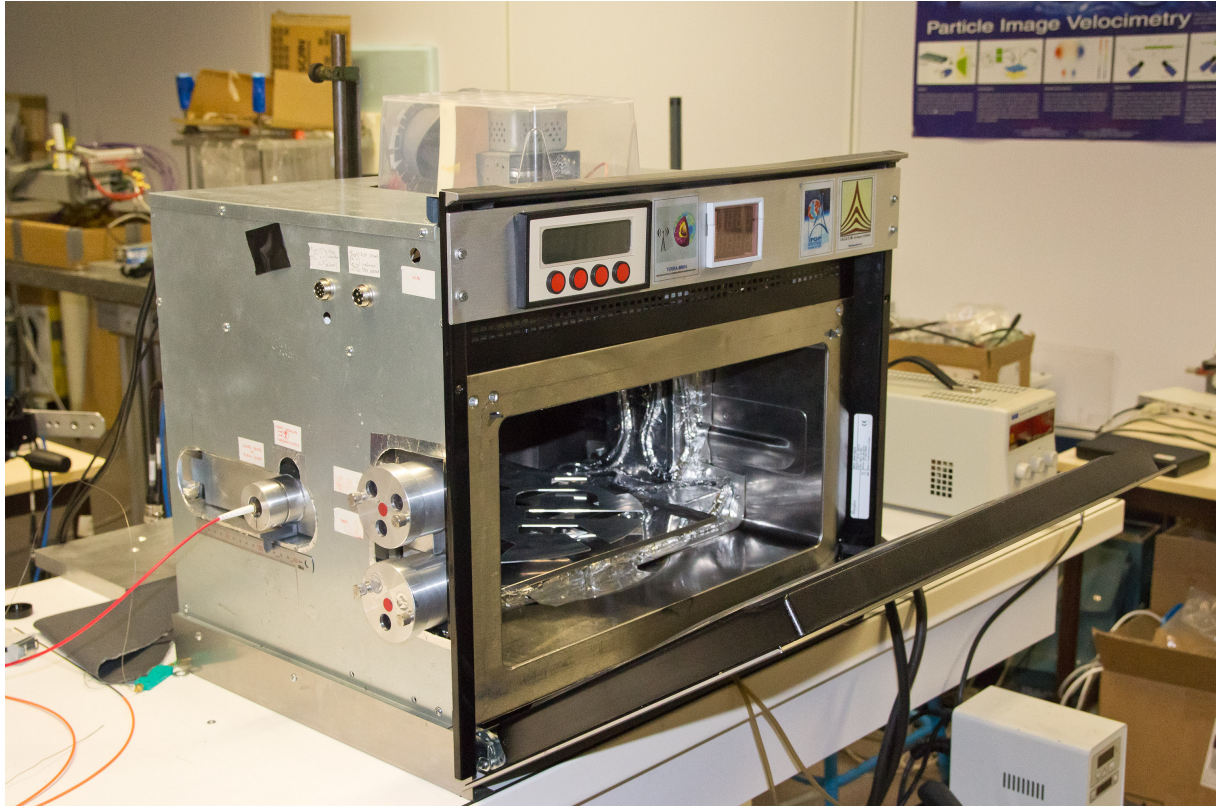
Fig. 20. Four à micro-ondes utilisé pour les expériences.
