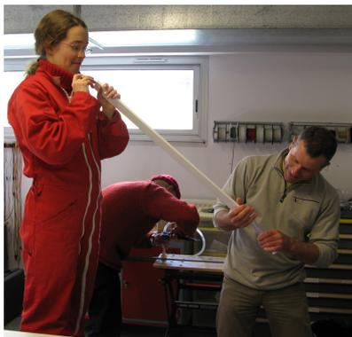
(a) Les fibres WLS sont collées dans les barreaux de scintillateur.
