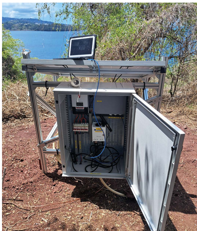
Installation de nouvelles stations sismologiques sur les îlots de Handréma et Mogné Amiri. Installation of new seismic stations on the islets of Handréma and Mogné Amiri.
