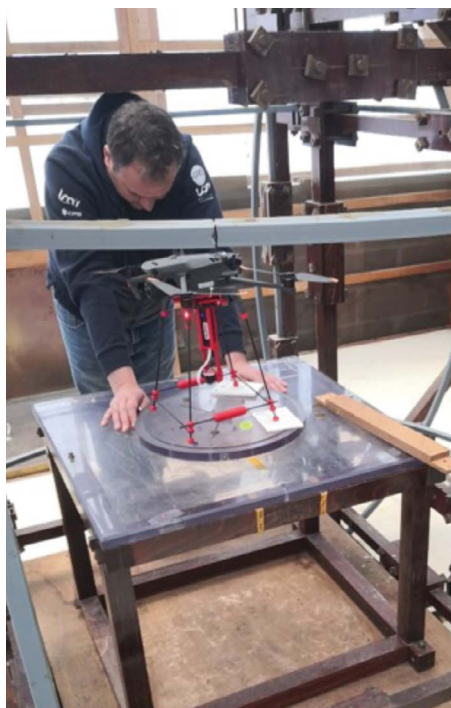
Calibration d'un drone utilisé lors de levés magnétiques à l'observatoire magnétique national. Calibration of a drone used for magnetic surveys at the national magnetic observatory.
