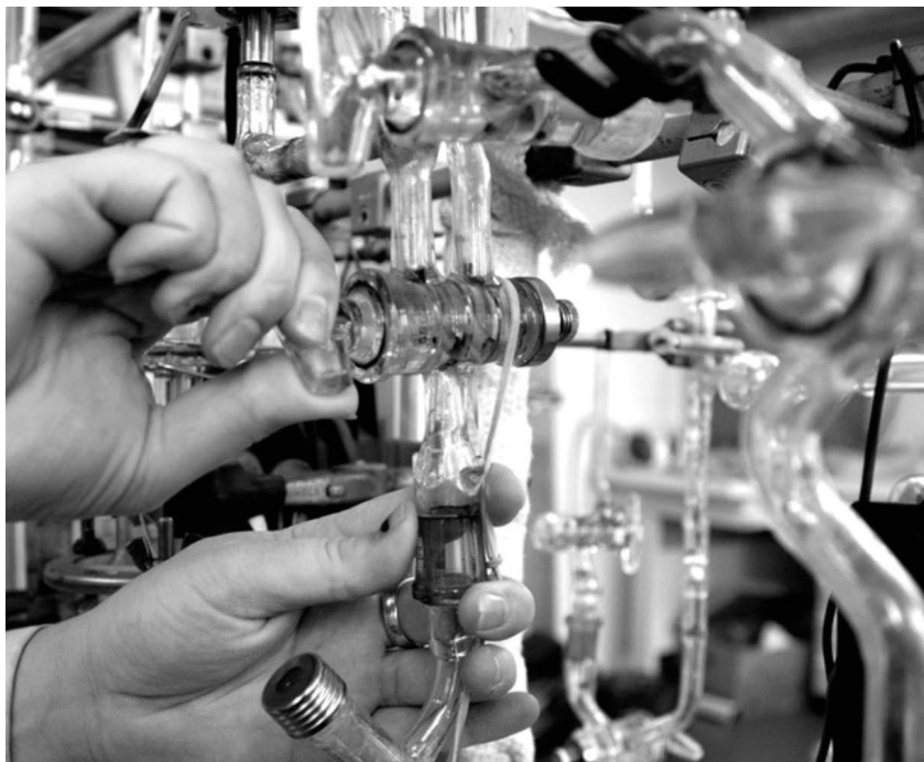
Illustration du travail sous ligne à vide nécessaire à la mesure des compositions isotopiques de l'azote dans les roches sédimentaires de cette étude. © Dars&Papilleau
