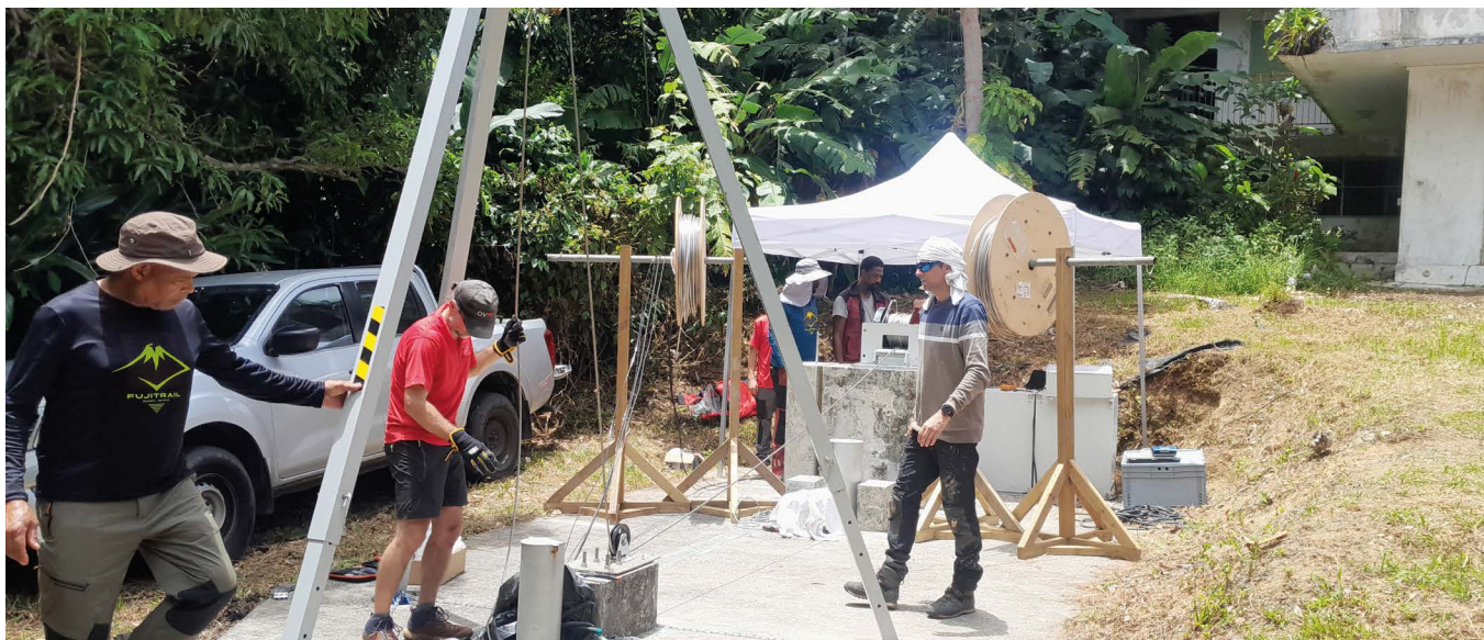
Installation du dispositif de descente du vecteur d'instruments en fond de puits sur le site IPGP de Parnasse à Saint Claude. Les deux bobines situées à hauteur d'homme servent à dérouler les tuyaux semi-rigide en acier inoxydable qui amèneront l'eau sous pression en fond de puits lors du retrait des instruments.
