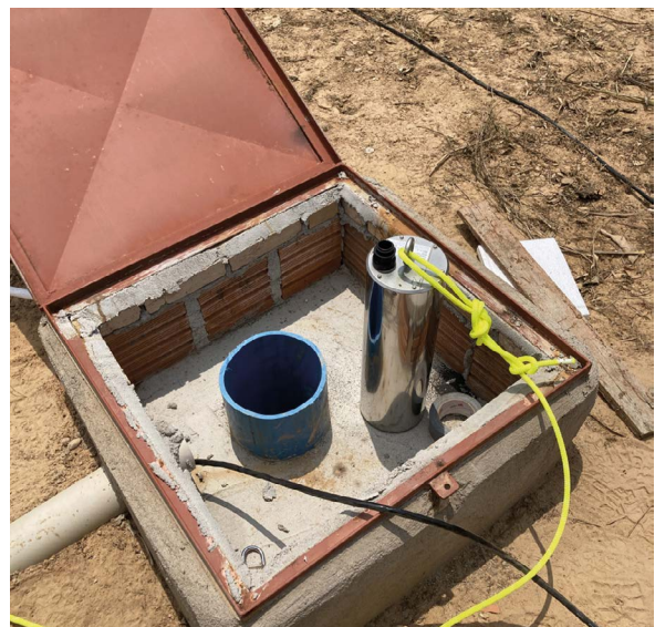
Nouvelle station MATO (Brésil), octobre 2024. Vue générale du site (à gauche) et vue du capteur T360 avant installation dans le puits de 24m de profondeur (à droite).
