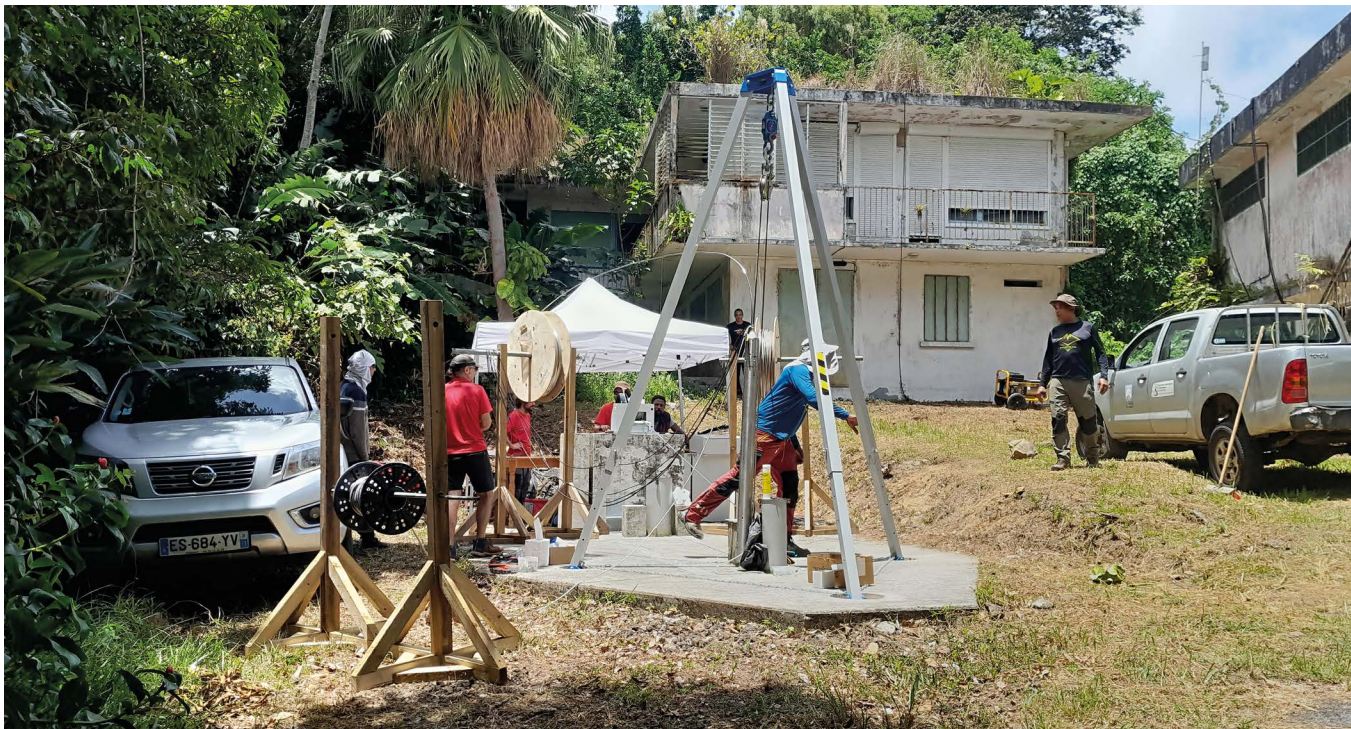
Installation et descente des instruments dans le forage de Parnasse par les équipes des observatoires volcanologiques de l'IPGP. Le vecteur mécanique rassemblant les instruments de mesure est suspendu au câble porteur via un trépied qui le renvoie au treuil. Le bon fonctionnement des instruments est contrôlé tout au long de la descente. Les câbles de communication et les tuyaux sont fixés tous les mètres au câble porteur.
