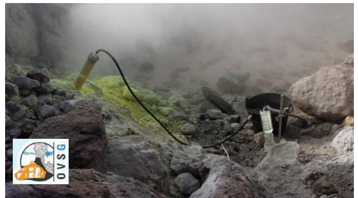
Figure 3 Ligne d'échantillonnage et prélèvement du gaz sec à la fumerolle CSC (© OVSG-IPGP, 24-11-2017).
