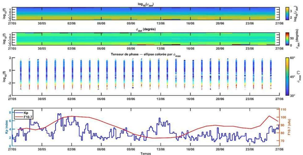
Figure 25 : Station Aéroport. Période du 28/05/2025 au 27/06/2025 – De haut en bas, chroniques temps-période de résistivité apparente de l’invariant 1D MT en échelle logarithmique, de phases, de tenseurs de phases journaliers et des index géomagnétiques Kp et f10.7 du réseau MT Revosima (©BRGM et REVOSIMA).
