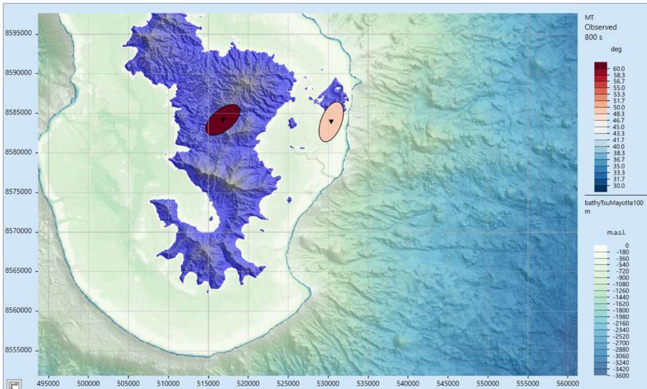
Figure 22 : Carte de tenseurs de phases calculés à 800 secondes des 2 stations MT actives du Revosima pour le mois de Juin 2025 (©BRGM et REVOSIMA). Les ellipses de tenseurs de phases sont colorées avec les valeurs de phase maximum  $\varphi_{max}$  (en degrés) qui sont supérieures à 45°, traduisant ainsi une décroissance de résistivité en profondeur.
