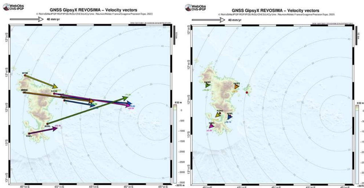
Figure 8 : Déplacements du sol enregistrés sur les stations GPS de Mayotte entre le 1<sup>er</sup> juillet 2018 et fin 2020 (à gauche) et sur les derniers douze mois (à droite). Les déplacements horizontaux sont représentés sous forme vectorielle et les déplacements verticaux sont indiqués par les valeurs chiffrées en couleur. Les données sont corrigées du mouvement de la plaque. Post-traitement de ces données réalisé par l'IPGP (©OVPF-IPGP / REVOSIMA).
