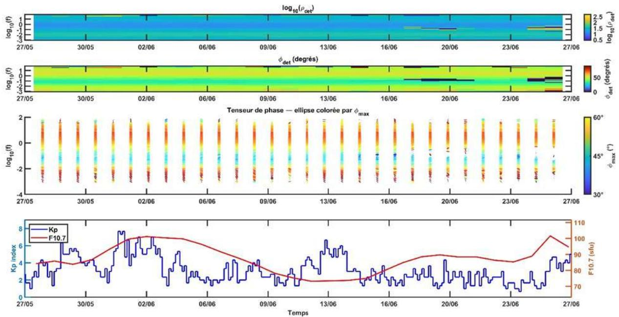
Figure 24 : Station Combani. Période du 28/05/2025 au 27/06/2025 – De haut en bas, chroniques temps-période de résistivité apparente de l’invariant 1D MT en échelle logarithmique, de phases, de tenseurs de phases journaliers et des index géomagnétiques Kp et f10.7 du réseau MT Revosima (©BRGM et REVOSIMA).
