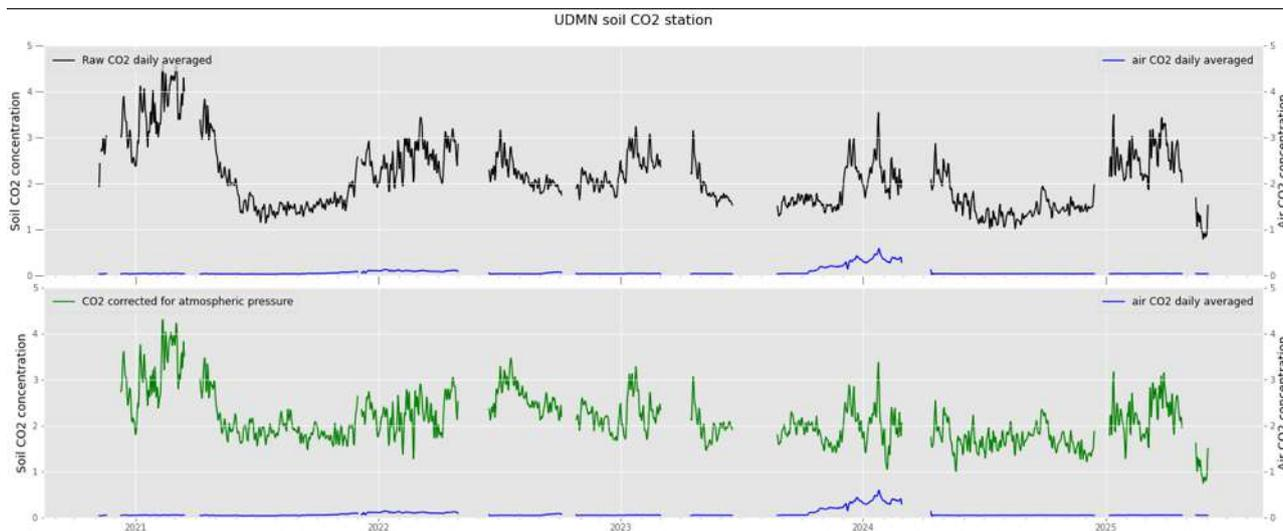
Figure 12 : Concentration en CO<sub>2</sub> dans le sol à la station permanente UDMN. Comparaison entre les données brutes (noir) et les données corrigées de l'influence de la pression atmosphérique (vert). Bleu : concentration du CO<sub>2</sub> dans l'air (1 m au-dessus du sol). Les variations de concentrations dans l'air sont liées à l'activité biogénique (©OVPF-IPGP / REVOSIMA). \*Du fait d'une panne sur la station le graphique n'a pas pu être mis à jour pour ce bulletin.
