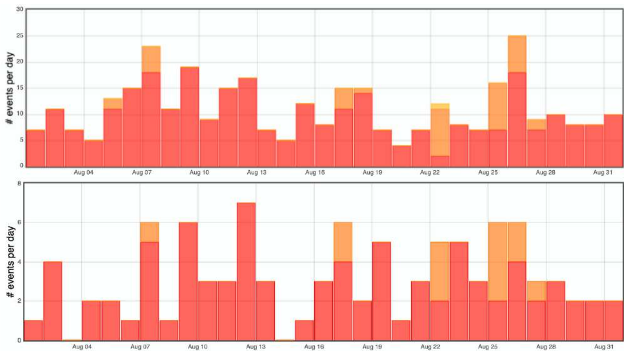
Figure 7 : Histogramme représentant le nombre de séismes par jour détectés (en haut) et localisés (en bas) en août 2026 par le réseau sismologique du REVOSIMA. En rouge les séismes volcano-tectoniques, en orange les séismes longues périodes, en jaune les séismes très longues périodes, en bleu les éboulements (© OVPF-IPGP et REVOSIMA).
