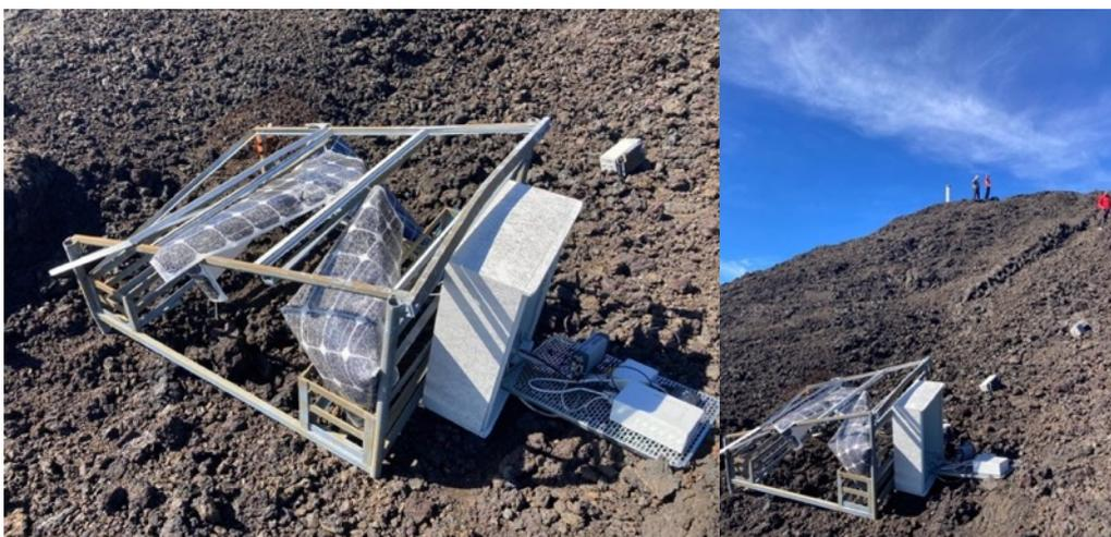
Figure A1 : station DERG (Dolomieu est) emportée et détruite par le cyclone Belal (photo du 18 janvier 2024).
