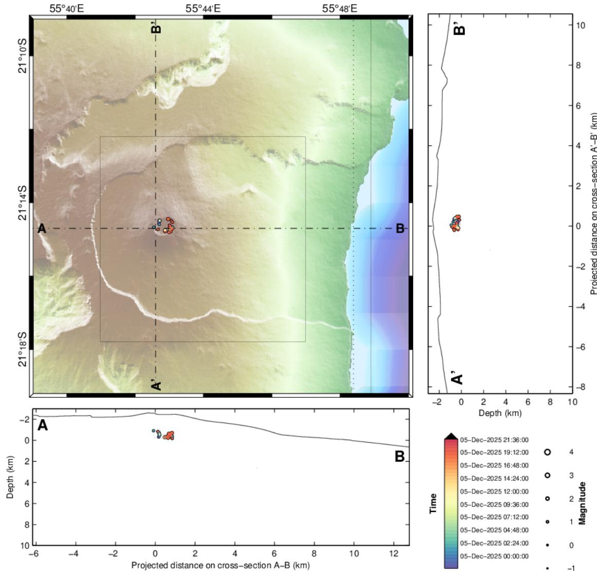
Figure 1 : Sismicité sous le Piton de la Fournaise le 05/12/2025. Carte de localisation (épicentres) et coupes nord-sud et est-ouest (montrant la localisation en profondeur, hypocentres) des séismes enregistrés et localisés manuellement par l'OVF-IPGP. Seuls les séismes localisables sont représentés sur la carte (© OVPF-IPGP).
