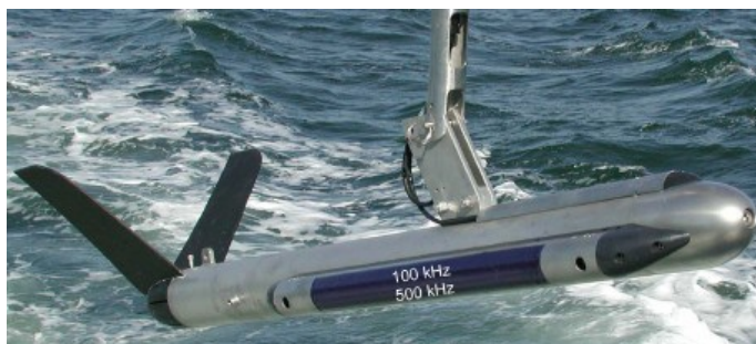
Figure 2 : Sondeur latéral pour imager le fond de la mer
