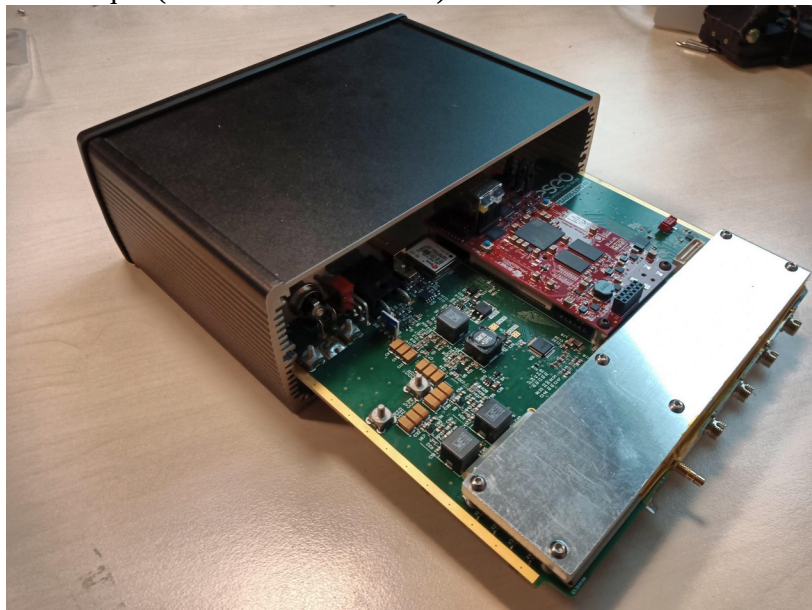
Figure 4 (à gauche) : Ensemble interrogateur dans sa valise de déploiement, avec de haut en bas, l'électronique, le conditionnement optique et la diode laser. Figure 5 (à droite) : Electronique de conditionnement et de traitement
