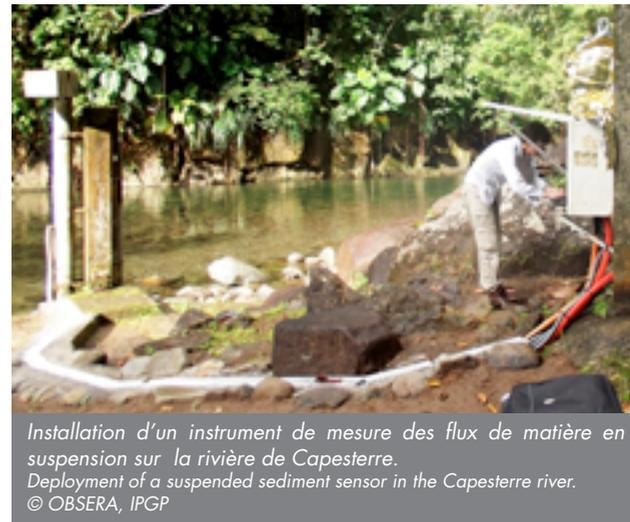
Installation d'un instrument de mesure des flux de matière en suspension sur la rivière de Capesterre.
