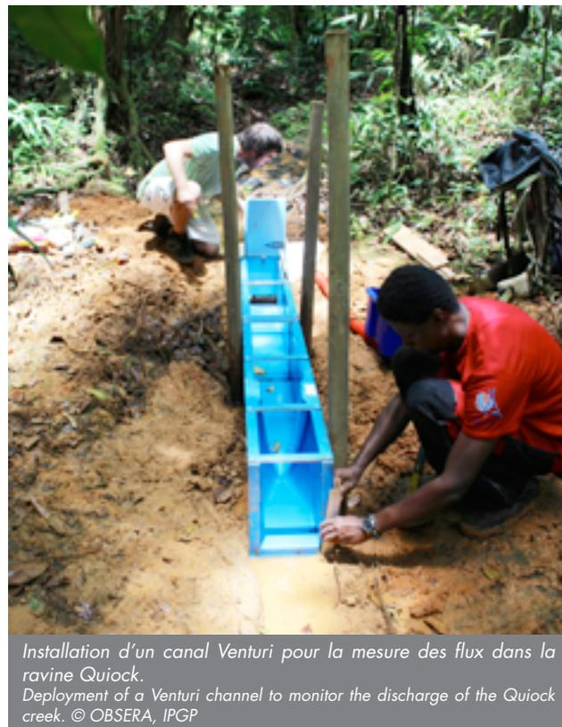
Installation d'un canal Venturi pour la mesure des flux dans la ravine Quiock.
