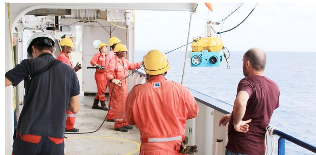
Récupération d'un des OBS (sismomètre de fond marin) mis à l'eau en février 2019. La partie jaune constitue les flotteurs de l'instrument. A droite, le drapeau et les deux tubes (flash et antenne) permettent de visualiser et communiquer avec l'instrument lorsque celui-ci est arrivé à la surface. La partie bleue est composée des batteries, du sismomètre et de l'électronique nécessaire à l'enregistrement des données.
