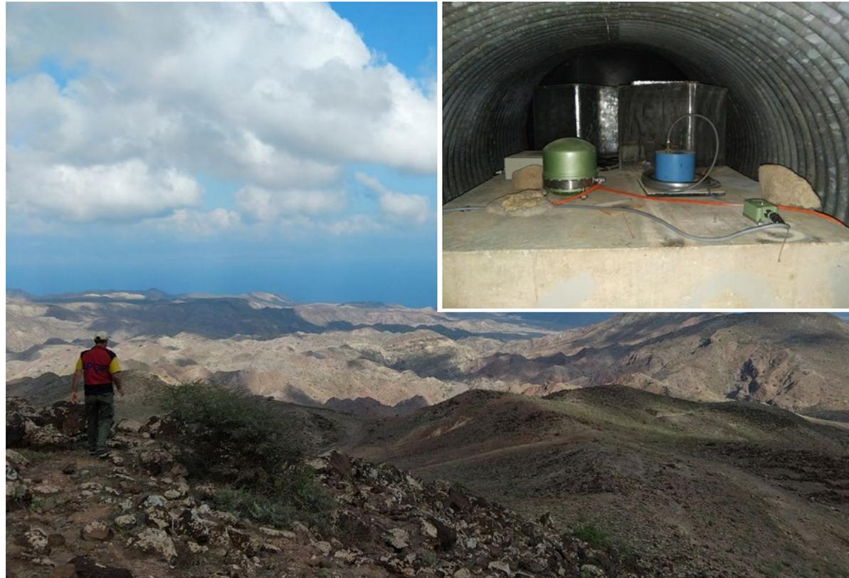
Intérieur de la cave sismique à Djibouti (avec le nouvel accéléromètre au premier plan) et vue des environs de la station.
