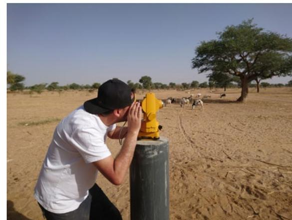
Mesures d'angle et de positionnement du pilier permettant la calibration de l'observatoire magnétique.
