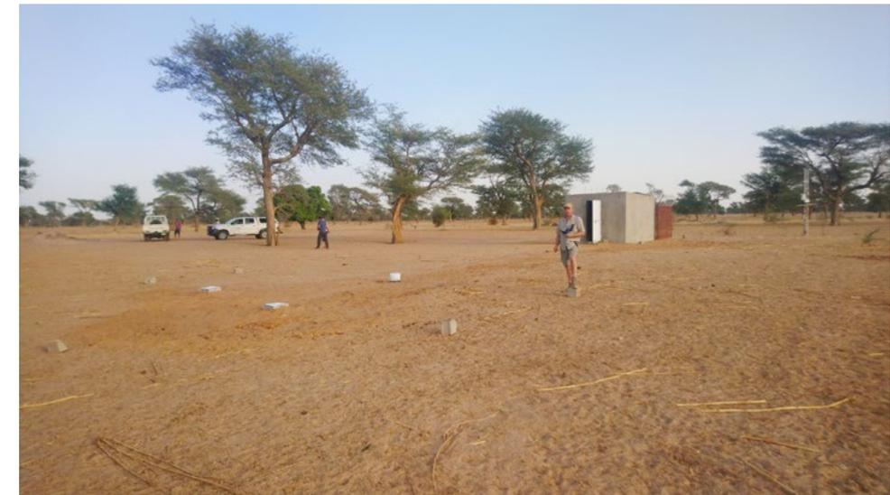
Les trois puits avec des couvercles blancs abritent l'instrumentation magnétique tandis que le local en béton contient les systèmes de gestion de l'énergie et de transmission des données, ainsi que l'instrumentation de GEOSCOPE.
