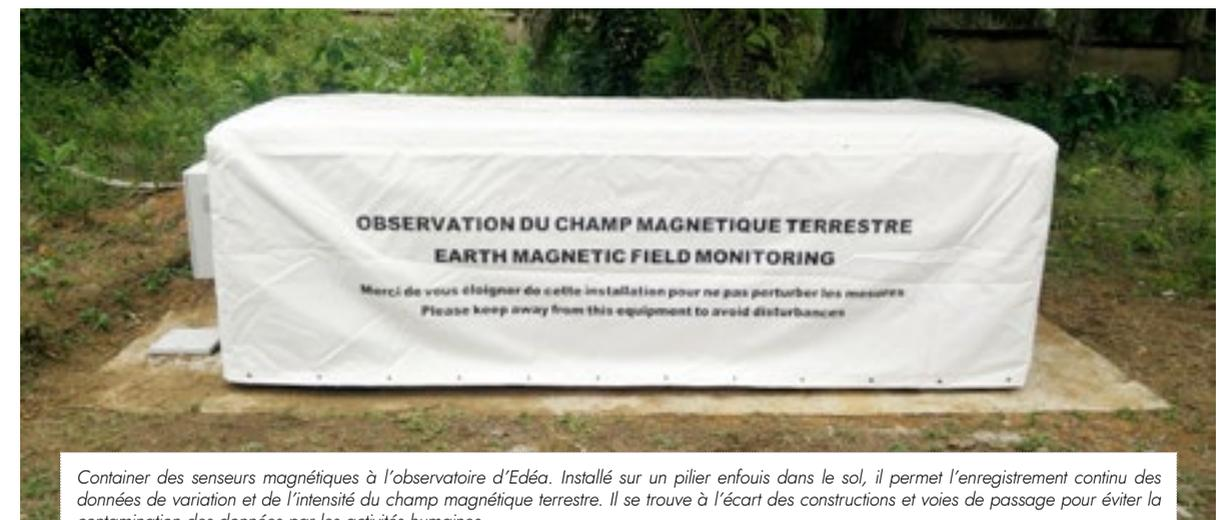
Container des senseurs magnétiques à l'observatoire d'Edéa. Installé sur un pilier enfouis dans le sol, il permet l'enregistrement continu des données de variation et de l'intensité du champ magnétique terrestre. Il se trouve à l'écart des constructions et voies de passage pour éviter la contamination des données par les activités humaines.
