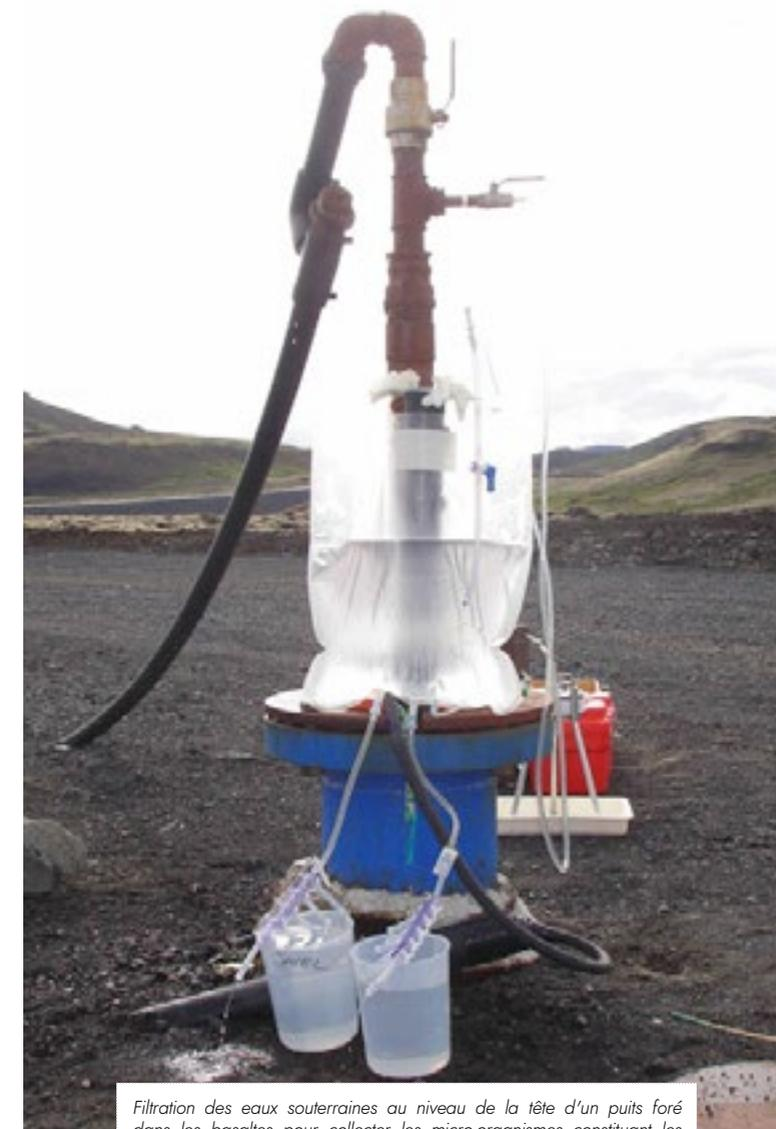
Filtration des eaux souterraines au niveau de la tête d'un puits foré dans les basaltes pour collecter les micro-organismes constituant les écosystèmes profonds. Groundwater filtration at the wellhead drilled in the basalts to collect the microorganisms present in deep ecosystems.
