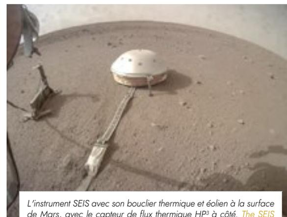
*L'instrument SEIS avec son bouclier thermique et éolien à la surface de Mars, avec le capteur de flux thermique HP3 à côté. The SEIS instrument with its heat shield and wind shield on the surface of Mars, with the HP3 heat flow sensor next to it. © NASA JPL-Caltech*
