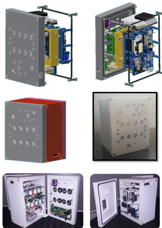
Figure 77 : Modélisation 3D, réalisation et assemblage du premier prototype.
