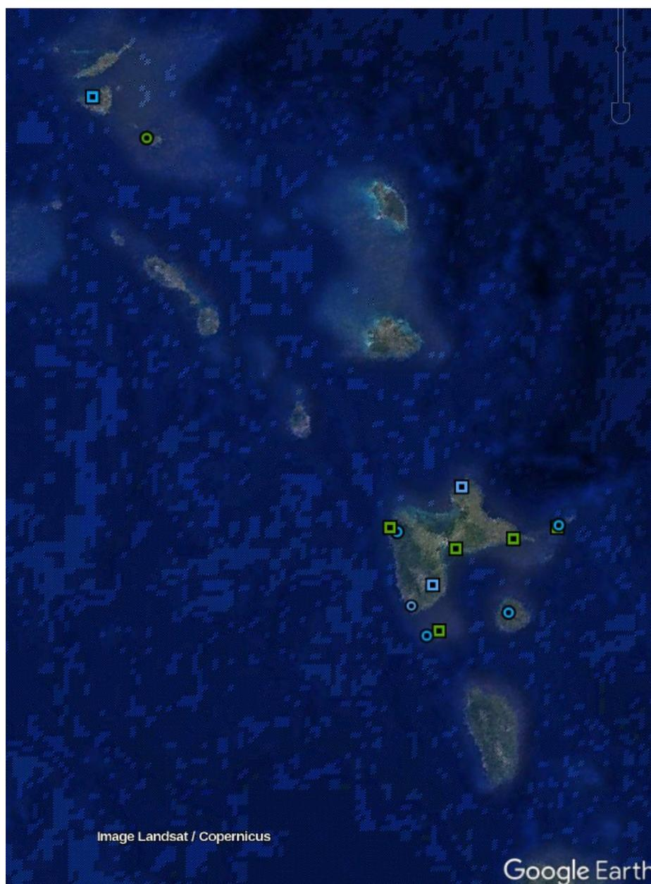
**Figure 2.10** Carte du réseau de GNSS continu dédié à la surveillance des déformations régionales. Les carrés symbolisent les sites qui ont intégré le réseau Teria en 2020. En bleu l'existant et en vert les sites instrumentés ou ayant bénéficié d'une importante remise en état en 2019.
