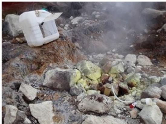
**Figure 2.20** Prélèvement d'une ampoule à soude et d'un condensat-saladier à NapN – 05/08/2020
