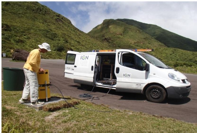
**Figure 2.11** Mesures de gravimétrie absolue effectuée sur la dalle géodésique de savane à Mulets en 2014
