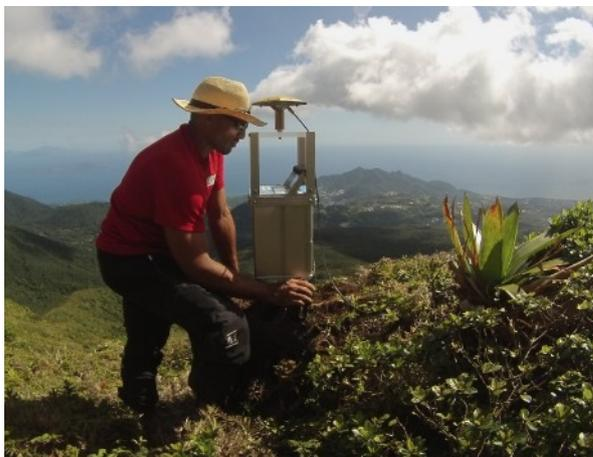
**Figure 2.12a** *Mesure de gravimétrie relative au sommet du dôme. L'antenne GNSS est placée sur le gravimètre à l'aide d'un support réalisé conçu spécialement pour ce lever.*
