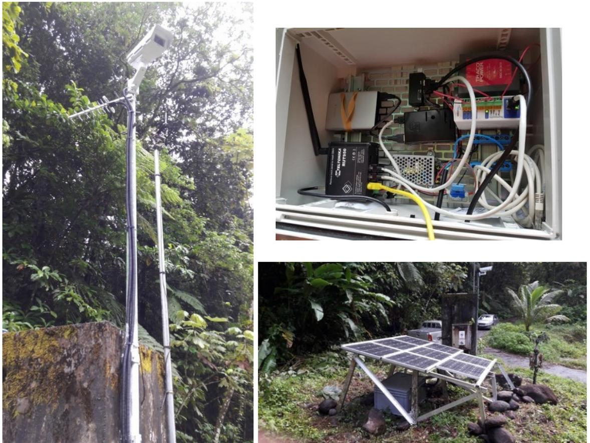
**Figure 2.25** : Caméra visible – site de CAP (gauche) ; Coffret d'acquisition de la caméra (en haut à droite) ; Nappe de panneaux solaires (alimentation caméra, CR800, CR200 et préleveur) (en bas à droite) ;
