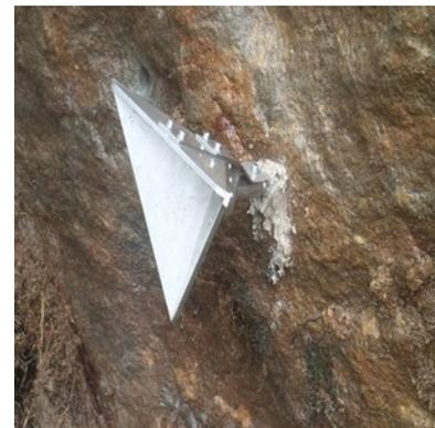
**Figure 2.16** Capteur (gauche) et cône réflecteur (droite) pour la mesure d'extensométrie Radar, faille du 30 Août
