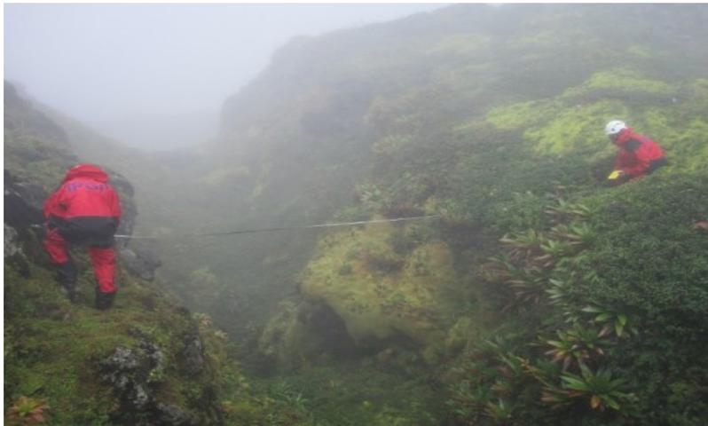
**Figure 2.14** Mesure d'extensométrie, faille du Nord-ouest, octobre 2013.
