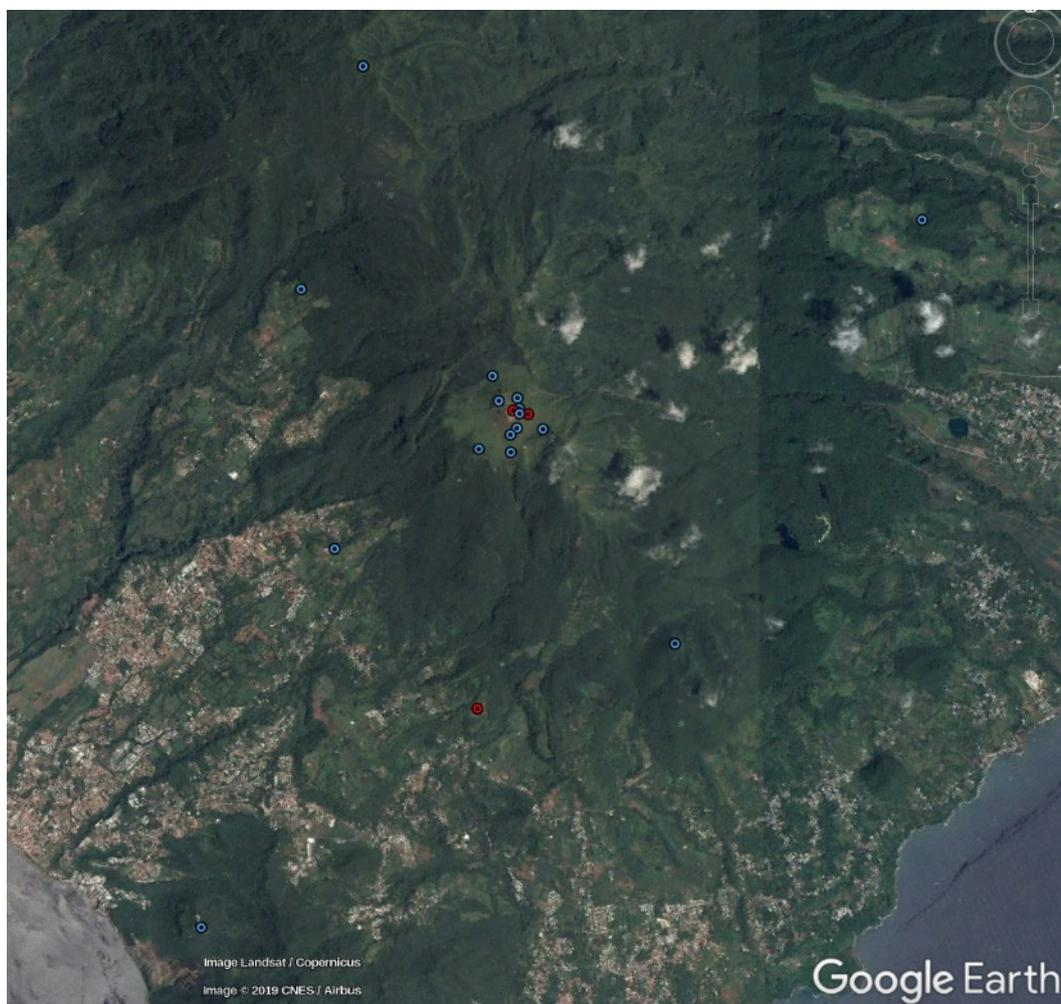
**Figure 2.8** Carte du réseau de GNSS continus dédié à la surveillance du volcan : En bleu l'existant et en rouge les sites sélectionnés pour compléter le réseau.
