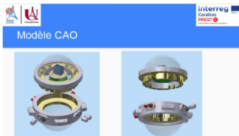
**Figure 33.** Développement d'un sismomètre de fond de mer.
