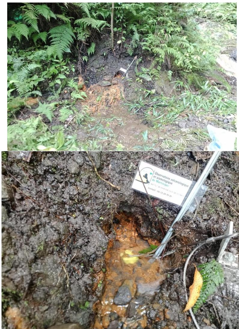
**Figure 23.** Installation dans la rivière Chaude d'une sonde de mesures de la température en continu de type Tinytag à la source hydrothermale n°4 (SC4).
