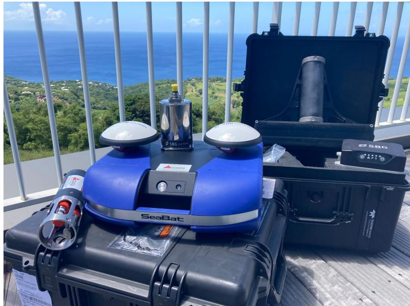
**Figure 46.** Vue des différents instruments qui composent la plateforme marine de PREST (J. Koziol).
