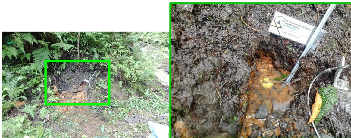
**Figure 39.** Sonde de mesure continue de la température installée au point n°4 des Sources Chaudes (SC4)
