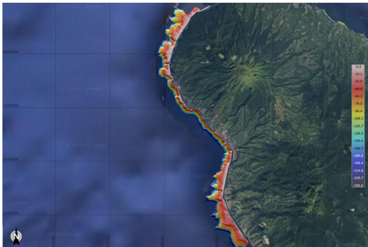
Figure 44 : Cartographie des fonds marins acquise avec le sondeur multifaisceaux du projet PREST le long de la côte nord Caraïbe.
