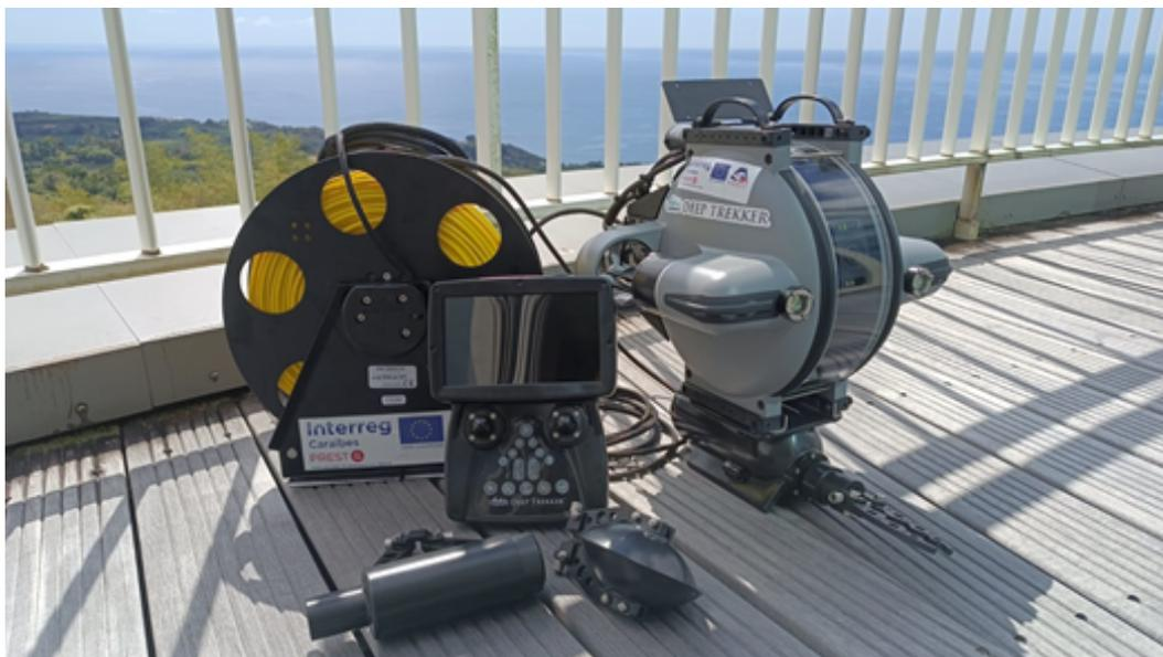
Figure 46 : ROV DTG 3 avec ses accessoires.
