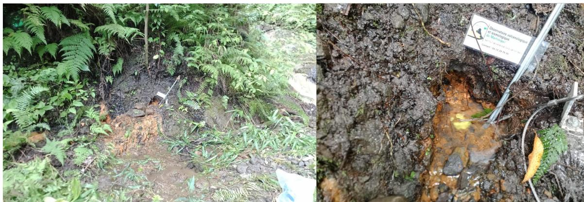
**Figure 22.** Installation à la source SC4 (à gauche) et zoom sur la sonde Tinytag immergée (à droite). Photos OVSM-IPGP
