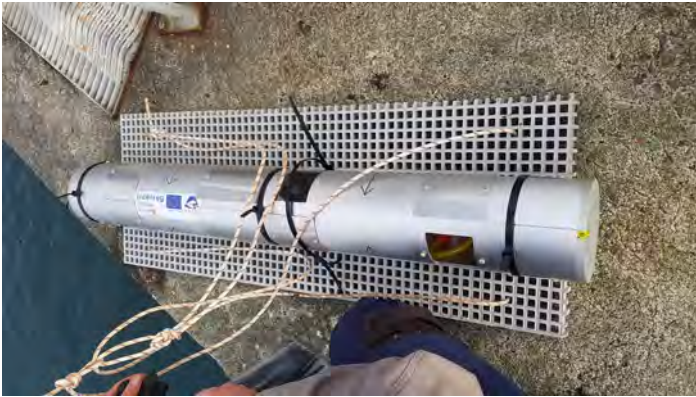
Pressiomètre optique en phase de test
