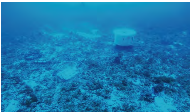
Campagne FIBROSAINTES de juin 2021. En haut, mise à l'eau des touques de protection. En bas à gauche, le sismomètre optique au fond de l'eau avant enfouissement et à droite un sismogramme.
