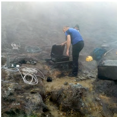
Fig. 48a. Installation d'un sismomètre Trillium 20s à proximité du cratère sud
