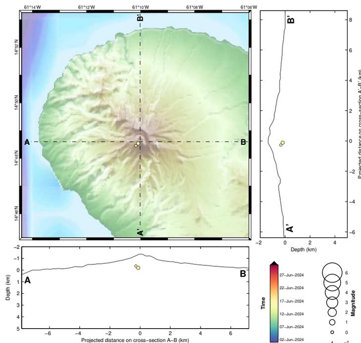
Figure 1 – Sismicité d'origine volcanique du mois de juin 2024 ayant pu être localisée au niveau de la partie superficielle de la Montagne Pelée, et coupes est-ouest et nord-sud indiquant la localisation en profondeur des hypocentres (source WebObs/OVSM).
