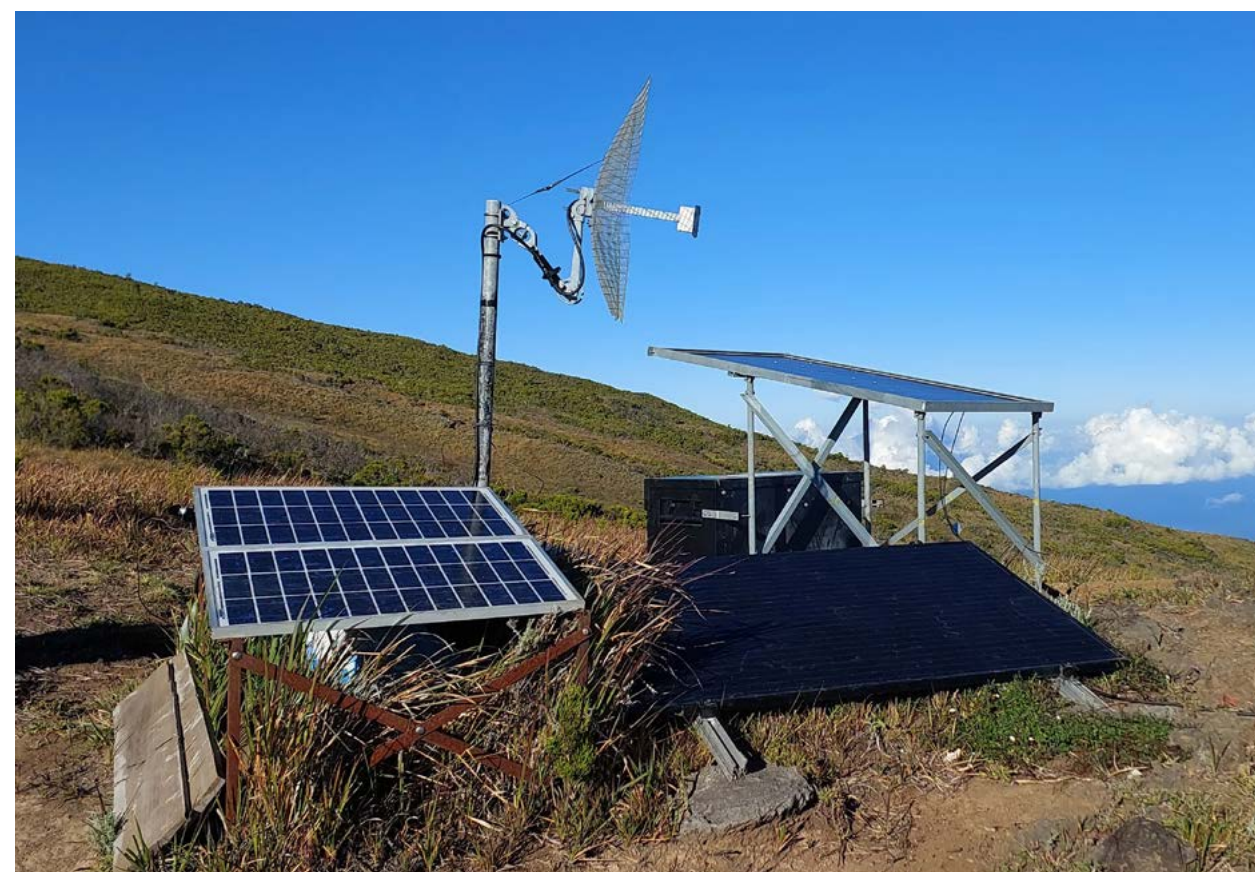
Installation d'une nouvelle station multiparamètres (sismologique, géodésique et géochimique) au sommet du volcan Karthala par l'équipe de l'OVK. Installation of a new multiparameter station (seismological, geodetic and geochemical) on the summit of the Karthala volcano by the OVK team.
