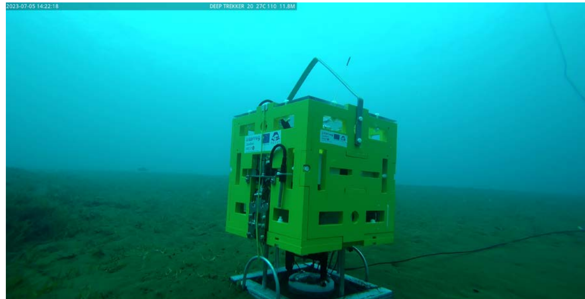
Sismomètre de fond de mer CUBI développé dans le cadre du projet PREST et testé en mer. CUBI ocean bottom seismometer developed as part of the PREST project and tested at sea.
