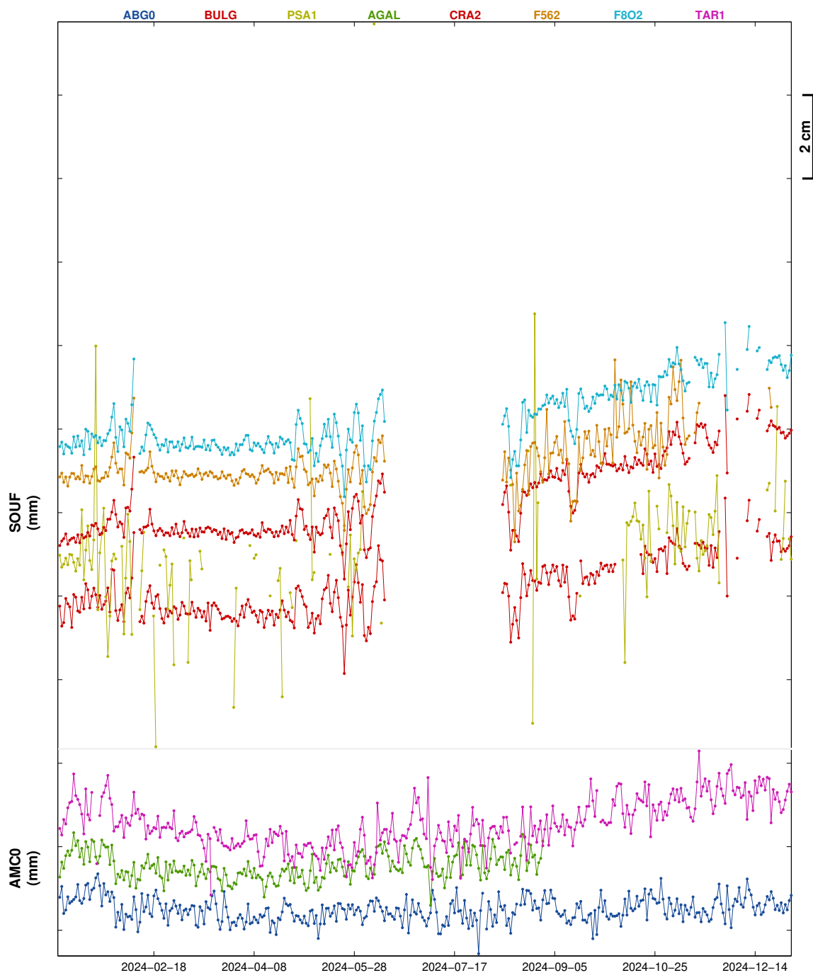
Figure 5. Evolution sur 1 an (1er janvier 2024 - 1er janvier 2025) des distances séparant les stations GNSS permanentes localisées sur le volcan de la Soufrière (voir figure 4 pour la localisation des stations)
