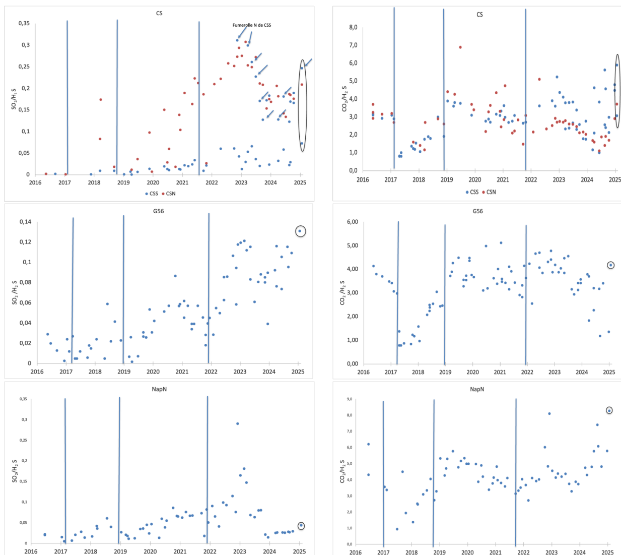
Figure 7: Évolution des rapports SO_2/H_2S et CO_2/H_2S dans les panaches de gaz émis par les événements CS (Cratère Sud), G56 (Gouffre 56) et Napoléon Nord (NAPN). Le site CS comprend un événement nord (CSN) et plusieurs événements sud (CSS). La bouche principale de CSS (flèches), la plus au nord et donc la plus proche de CSN, a la même composition que CSN. Les lignes bleues marquent des changements de compositions chimiques observées sur la plupart des sites (Mars 2017; Décembre 2018; Octobre 2021). Les cercles noirs indiquent les dernières mesures effectuées le 29/01/2025.
