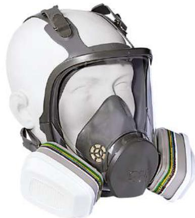
Figure 58 : Masque facial intégral type 3M série 6000 équipé de filtres 6099 (A2B2E2K2HgP3 R + form) (Filtre de classe 2). Ce type de filtre est adapté aux vapeurs organiques, gaz inorganiques, gaz acide, ammoniac, formaldéhyde, vapeurs de mercure et particules.
