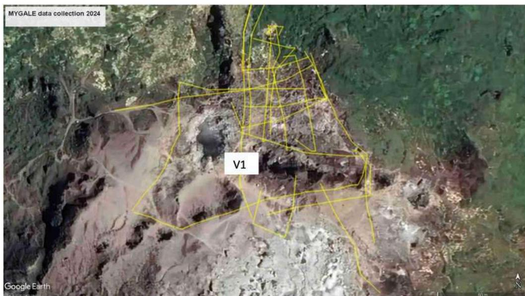
Figure 46. Localisation des profils de résistivité électrique acquis en avril et mai 2024 au sommet de La Soufrière de Guadeloupe. Le profil V1 est indiqué dans sa partie la plus méridionale.
