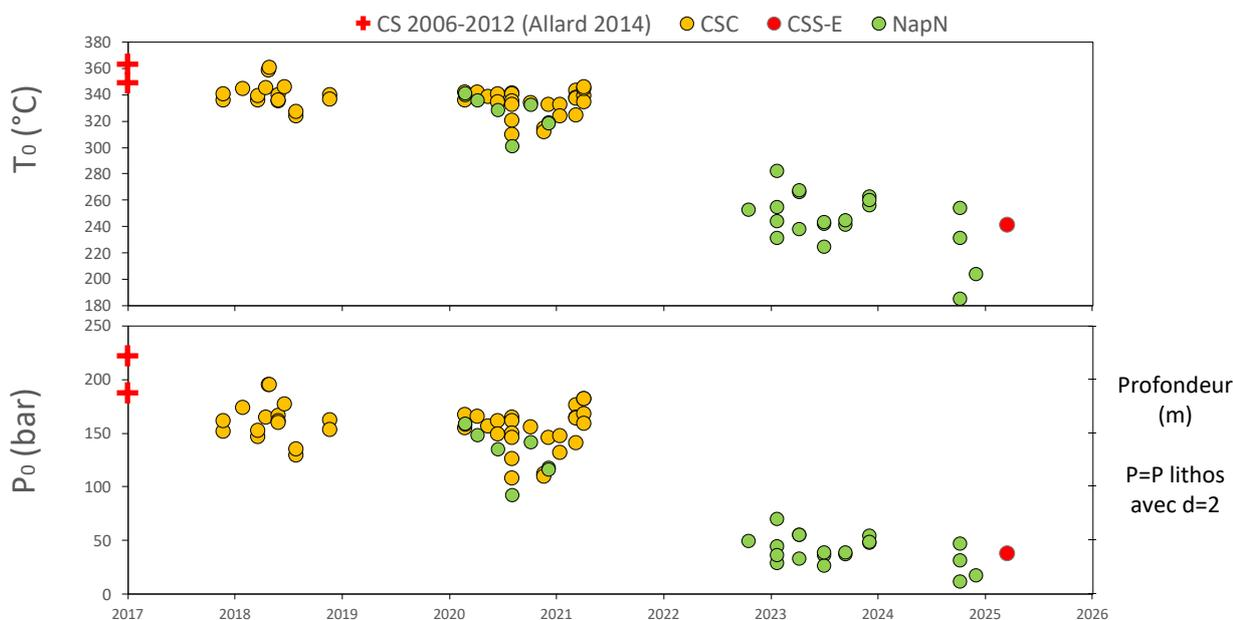
Figure 7: Température et pression d'équilibre des gaz de la Soufrière de Guadeloupe déduites des abondances relatives de  $H_2O-H_2$  et  $CO_2-CO-CH_4$  (Modèle thermo-barométrique de Chiodini et Marini, 1998).
