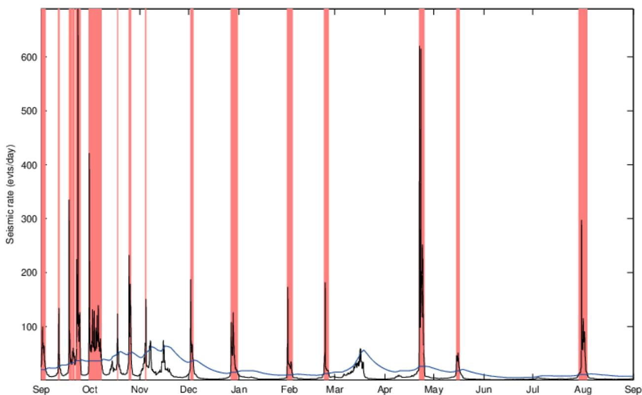
Figure 2. Taux instantané de sismicité volcano-tectonique (VT) entre le 1<sup>er</sup> septembre 2024 et le 1<sup>er</sup> septembre 2025 (courbe noire). Les bandes rouges caractérisent les essaims sismiques (voir les définitions de ces paramètres en annexe). Taux moyen de sismicité sur les 60 jours précédents (courbe bleue, figée pendant les essaims).
