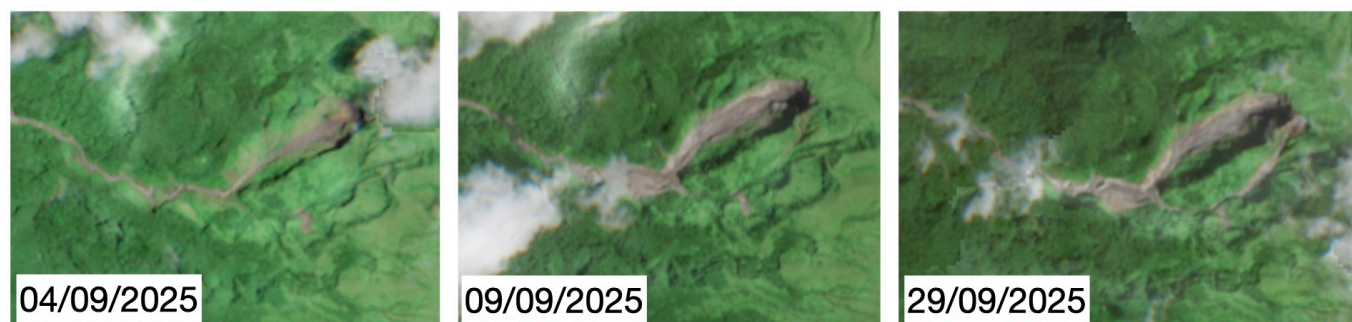
Figure 14 – Évolution de la morphologie de la falaise Samperre au cours du temps. Imagerie satellitaire Sentinel-2.
