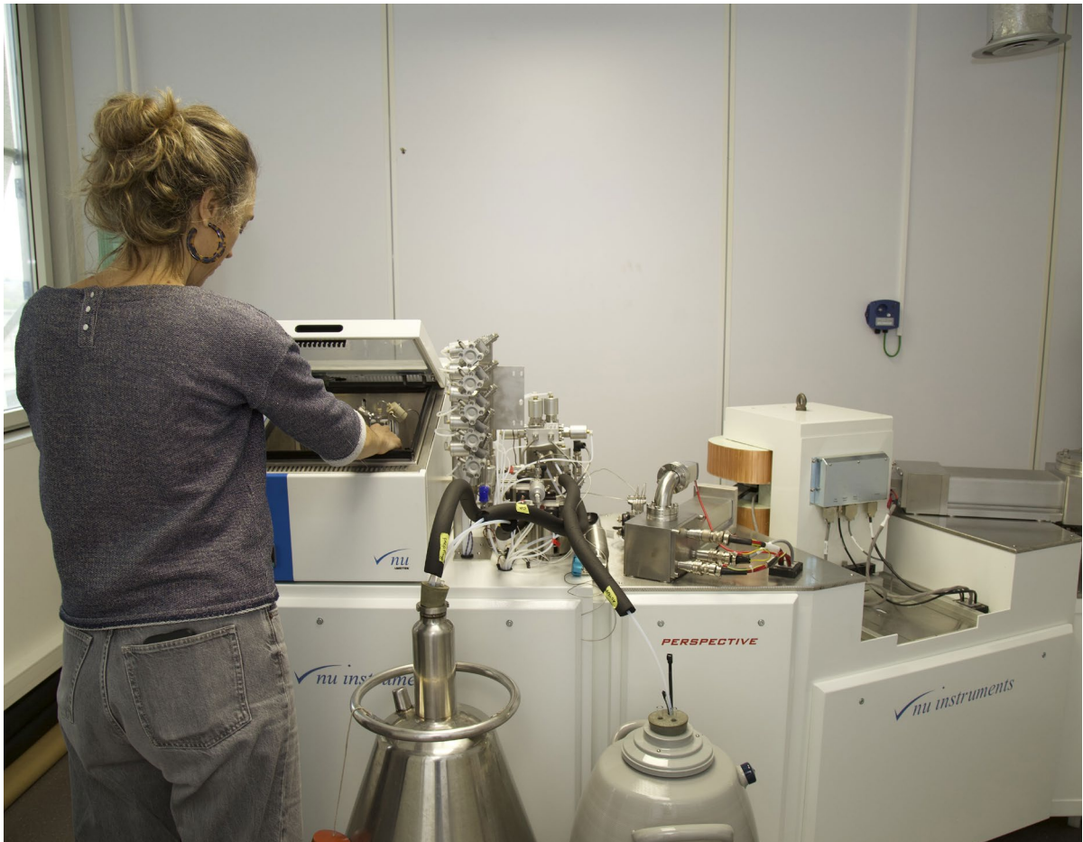
Instrumentation dédiée aux mesures duales \Delta_{47}-\Delta_{48} : spectromètre de masse (à double introduction et secteur magnétique) pour l'analyse du \text{CO}_2 gazeux extrait des minéraux carbonatés par un système de préparation/purification couplé.
