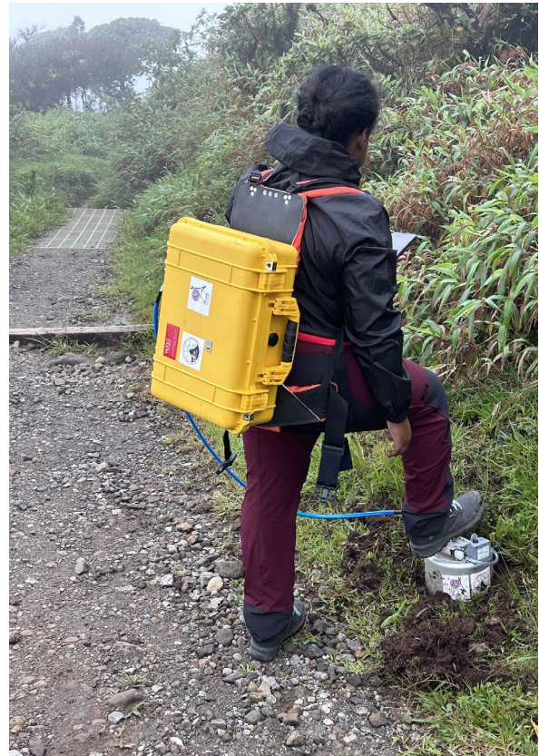
Mesure du flux de CO 2 au sol réalisée sur le sentier menant au sommet de la Montagne Pelée par Tracy Abauzit, assistante-ingénieure à l'OVSM-IPGP financée sur contrat par le MTECT.
