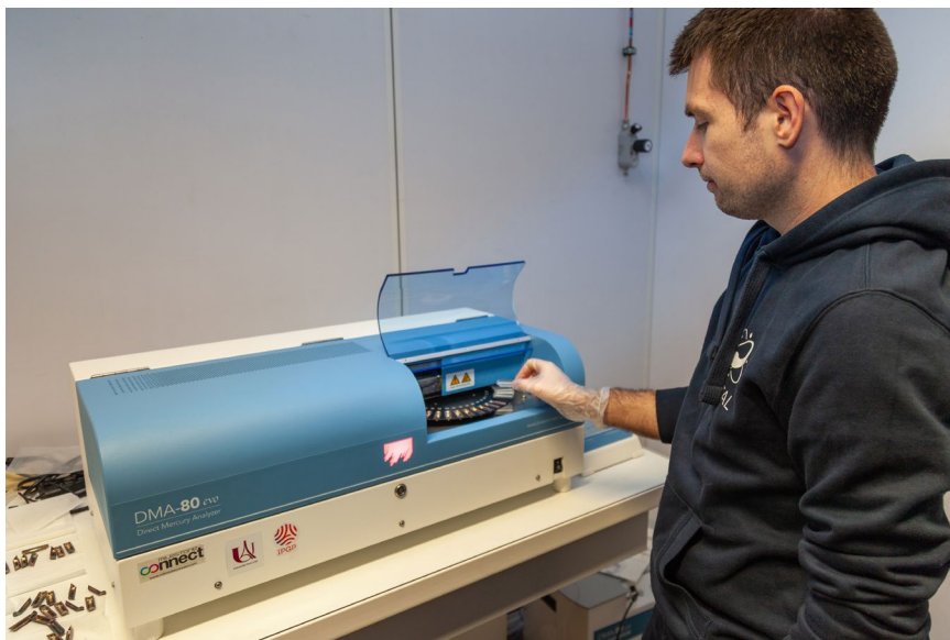
La plateforme PARI s'est dotée fin 2025 d'un analyseur mercure à combustion directe pour l'analyse des échantillons liquides et solides. The PARI platform acquired a direct combustion mercury analyzer at the end of 2025 for the analysis of liquid and solid samples.
