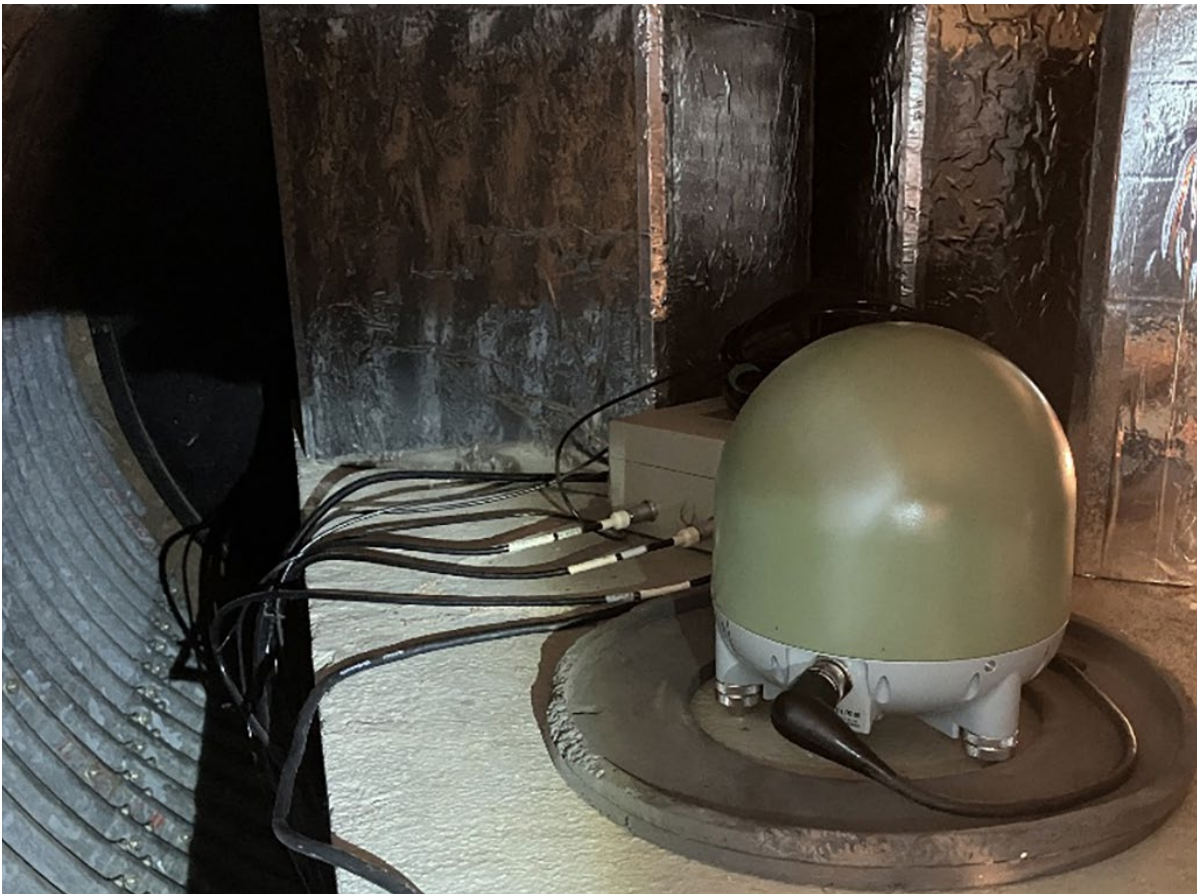
Le nouveau capteur T360 installé à la station ATD (Djibouti) en décembre 2025.
