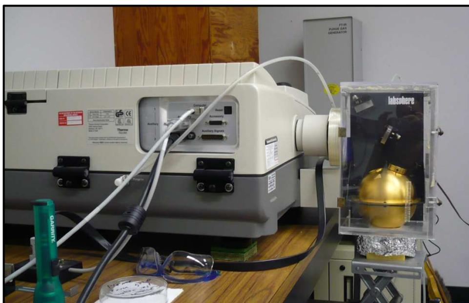
Figure 2.3 : Nicolet Nexus 670 couplé à une sphère intégrante Labsphere - USGS Spec Lab. La sphère intégrante et les miroirs sont placés dans une enceinte de mesure en atmosphère neutre.
