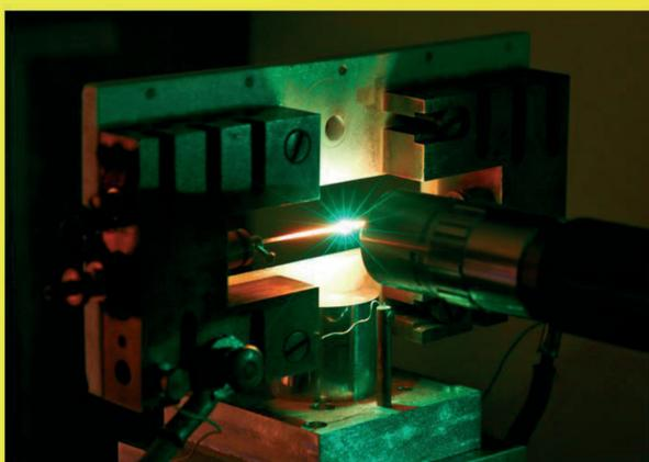
Le micro-four sur le spectromètre Raman, en vert le faisceau laser
